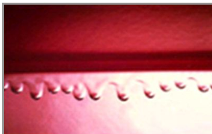
Escorridos - Escorridos de tinta nos elementos da carroçaria do veículo.
